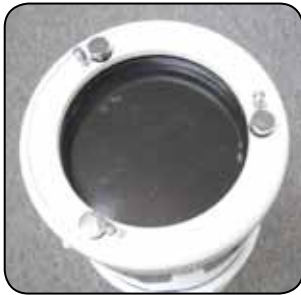
HAUPTSPIEGEL. DIE GROSSEN DAUMENSCHRAUBEN DIENEN ZUR KOLLIMATION UND DIE KLEINEN DAUMENSCHRAUBEN DIENEN ZUR ARRETIERUNG DES SPIEGELS.
