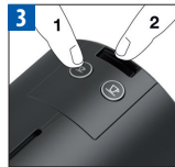
3 에스프레소 버튼을 누른 상태에서 머신 전원을 켭니다. 더 이상 물이 배출되지 않을 때까지 기다립니다.
