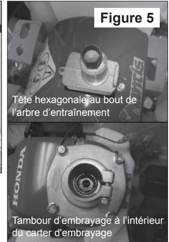
Le moteur est engagé jusqu'au fond sur le réducteur.
