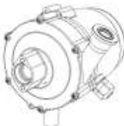
Pompe de recirculation
